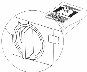
**Παρατήρηση:** Η μπαταρία χρησιμεύει μόνο για να κρατάει το πρόγραμμα στη μνήμη του προγραμματιστή σε περίπτωση διακοπής του ρεύματος. Για να λειτουργήσουν οι ηλεκτροβαλβίδες, πρέπει να υπάρχει σύνδεση με το ηλεκτρικό ρεύμα 220V.
